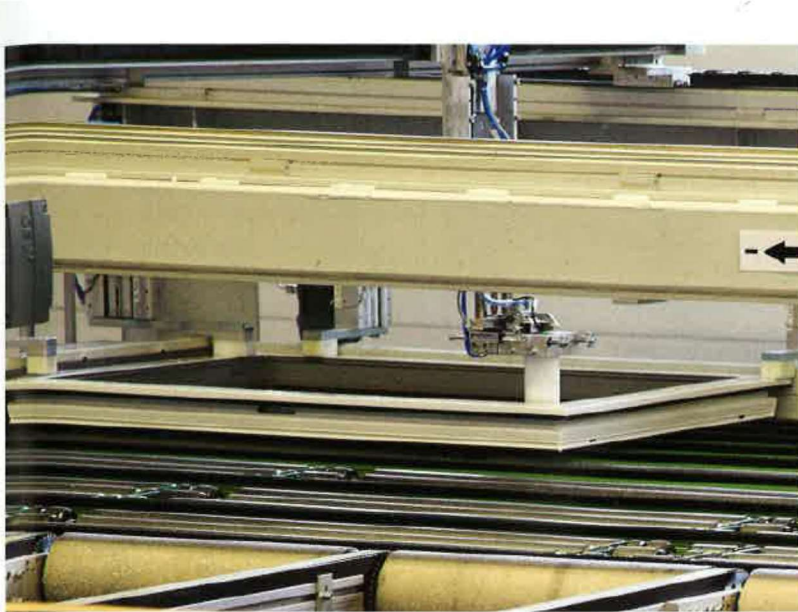
Die Glashalteleisten-Ausmesseinrichtung ermittelt durch Abtasten der Glasöffnung die daraus resultierenden Längen der Glashalteleisten. Foto: bauelemente bau
