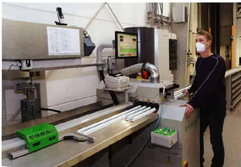
Die vollautomatische Glashalteleistensäge von Urban ist in der Lage, ohne Kontur-Zulagen vier Glashalteleisten gleichzeitig zuzuschneiden. Foto: bauelemente bau
