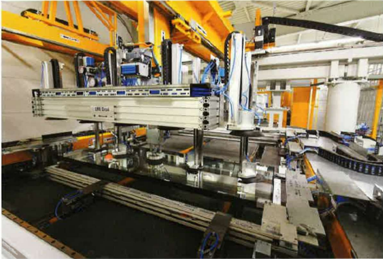
Nach dem automatischen Eintransport der Flügel werden diese automatisch mit Hilfe von Spannelementen exakt rechtwinklig ausgerichtet, bevor die Scheibe Laser- und Ultraschall vermessen wird und anschließend exakt positioniert eingesetzt wird. Foto: Arndt
