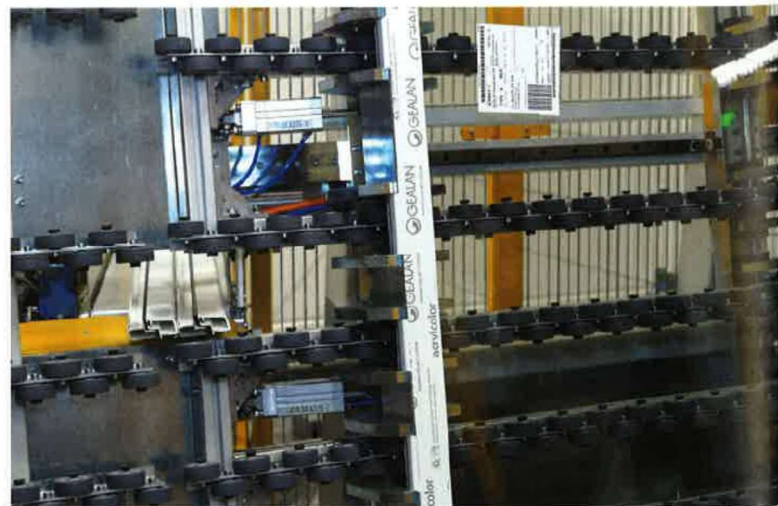
Über ein Förderband gelangen die exakt auf Maß zugeschnittenen Glashalteleisten direkt an die Arbeitsstation, an der sie benötigt werden. Foto: bauelemente bau
