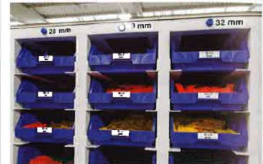
Der exakt passende Verglasungsklotz wird dem Mitarbeiter durch eine Leuchte am Regal angezeigt. Foto: bauelemente bau
