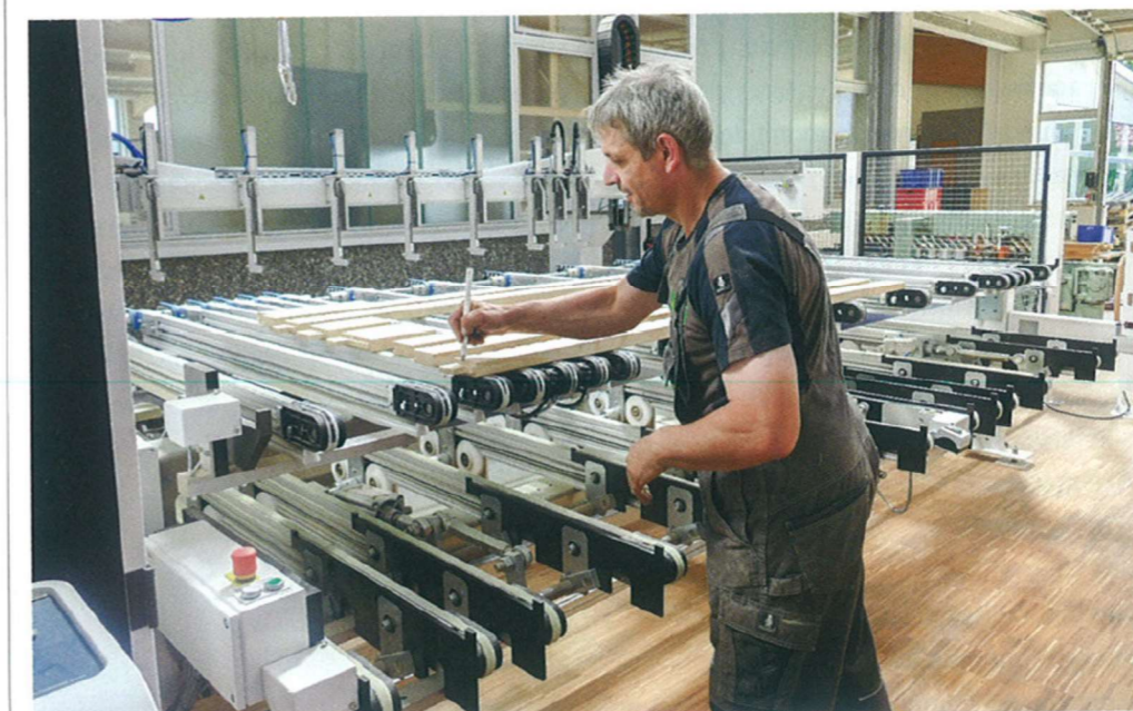
Die fertigen Rahmenteile der Klappläden werden nach dem Fräsen über einen verdeckt liegenden Zapfen miteinander verbunden.
